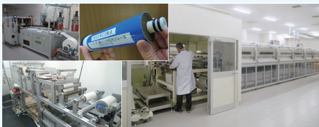
図3 多品種の膜・モジュールの試作ができる国内唯一の拠点として強みを有する、実証で活用している試作ライン等の設備(信州大学工学部内:長野市)
