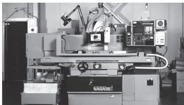
世界初の全軸油静圧超精密CNC研削盤SGU-52
